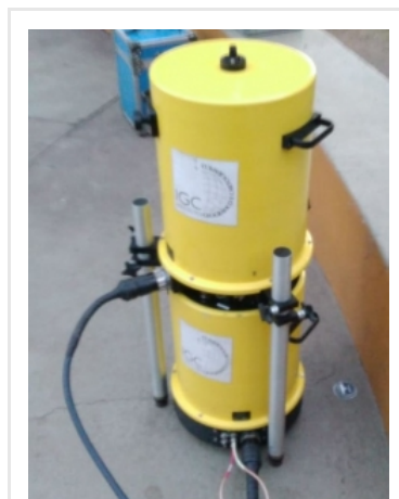
Gravímetro absoluto utilizado nas medições (foto: arquivo do pesquisador)
