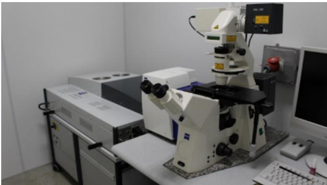
*Microscópio de varredura a laser confocal é um dos equipamentos da Relam. (Foto: Arquivo Propp)*
